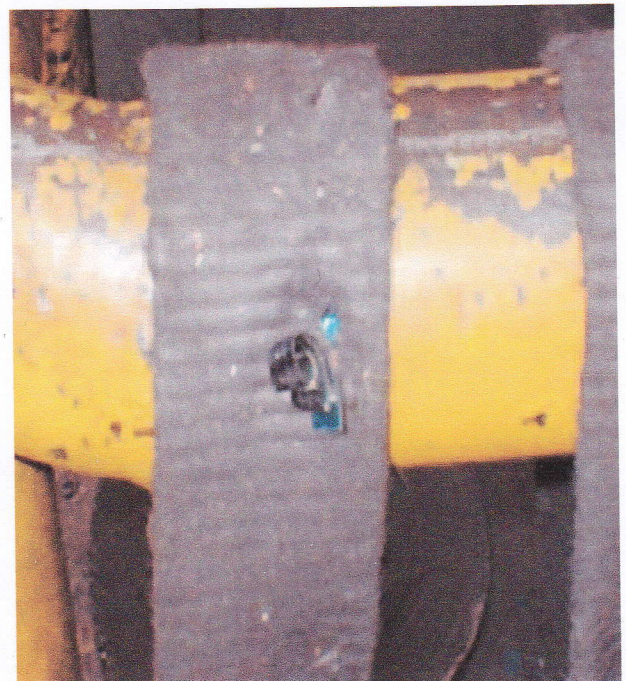
Bild 4-4: Durch heißen Span beschädigte Oberfläche
